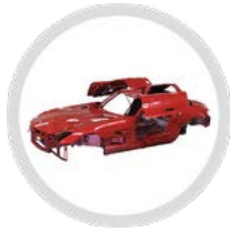
Mercedes-Benz SLS AMG Aluminiumkarosserie (2009 – 2014)
